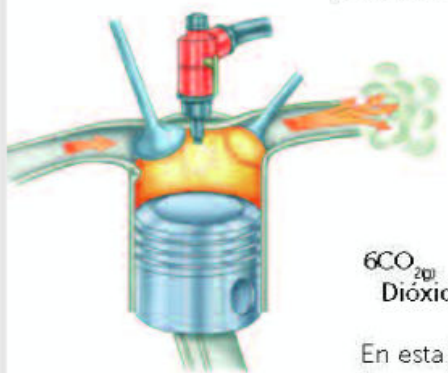
Figura 4.18 La energía que genera la combustión de la gasolina en el motor de un automóvil es la que lo pone en movimiento.
