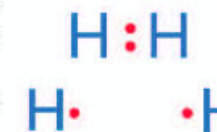
Figura 4.20 Cuando los átomos que se enlazan son del mismo tipo, los electrones en el enlace se distribuyen de manera equitativa.
