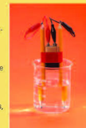
Asegúrense de que la pila quede arriba de la superficie del agua.
