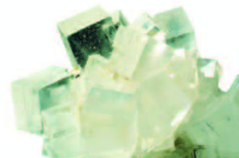
Figura 2.47 Un cristal de cloruro de sodio ( NaCl ) o sal de mesa está formado por iones de Na^+ y Cl^- que se atraen fuertemente debido a que poseen cargas contrarias.
