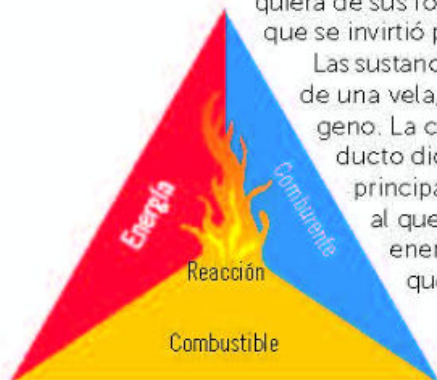
Figura 4.17 Triángulo de la combustión.
