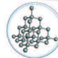
Figura 2.50 En el diamante, cada átomo de carbono (C) está unido covalentemente a otros cuatro.
