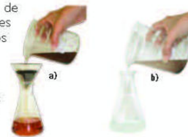
Figura 1.24 a) Filtración. b) Decantación.
