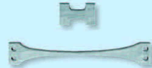
Aleación original de cinc-aluminio-plata y la misma aleación deformada al 800% a una temperatura de 280 °C.
