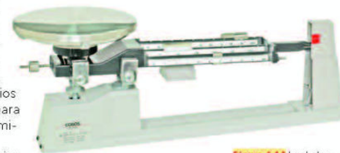
Figura 1.14 Las balanzas granatarias tienen un platillo donde se colocan las muestras y brazos laterales, en los que se colocan pesas deslizables.
