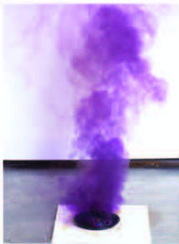
Figura 3.7 El aluminio (Al) reacciona con el yodo (I 2 ) para producir yoduro de aluminio (AlI 3 ).
