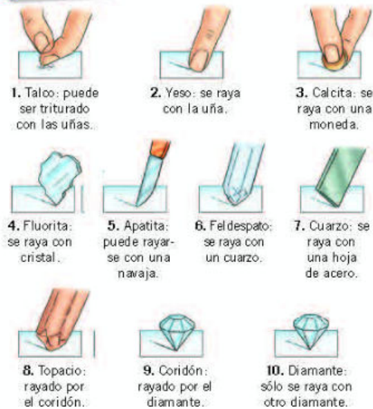
Figura 1.9 Escala de dureza de los materiales.
